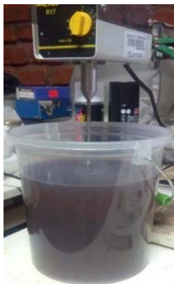
Figura 2. Formación de Complejos y Precipitación con sales Férricas.[3]
